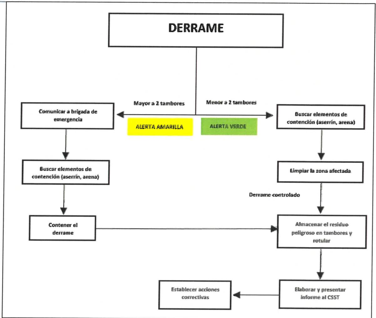
Figura 7. Instructivo para la respuesta y control de derrames.
